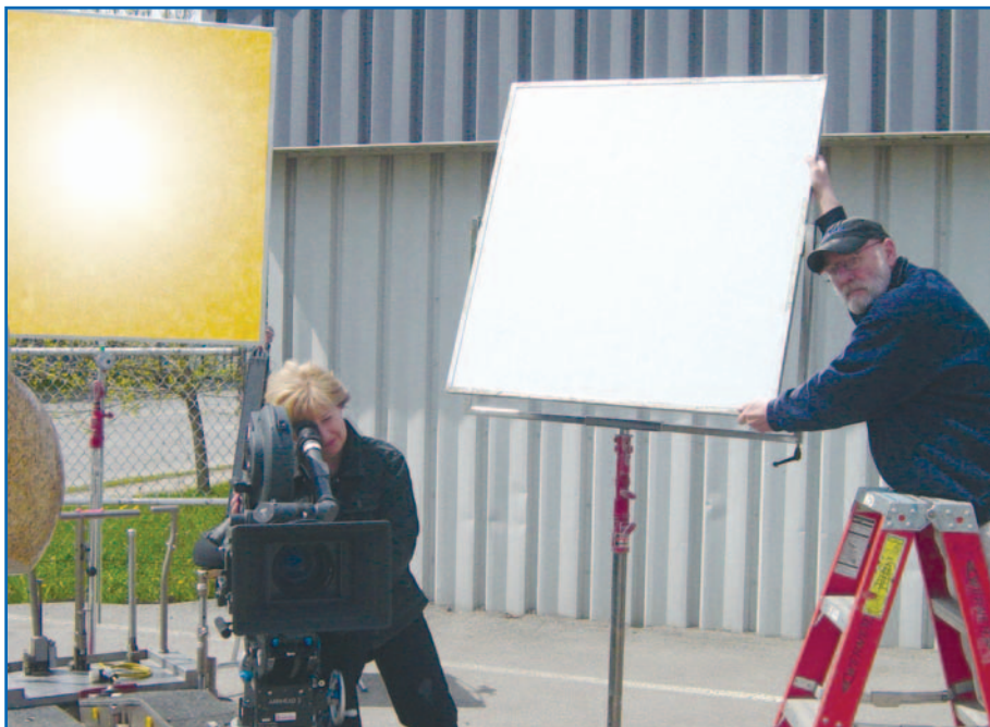
Grips, Gaffers y otros técnicos preocupados con la calidad de luz frecuentemente utilizan más de un material de reflexión Rosco para obtener el resultado exacto que quieren. En esta situación, por ejemplo, el cineasta cubrió una tabla con Roscoflex S para una reflexión suave. Pero como se necesitaba un color un poco más cálido, Roscoflex G se fijó a una tabla acompañante.
